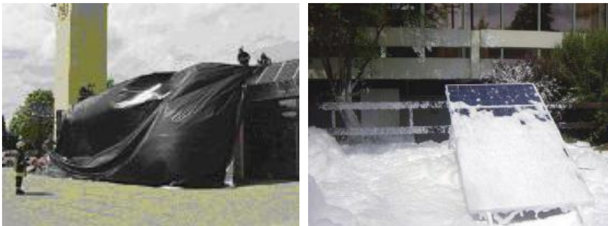
Figure 5-44: Tests on lightproof covering of PV modules, photo: http://pv-notaus.de/gefahren.html
