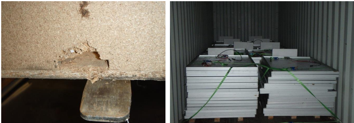
Bild 5-22: Links: Falsches Handling mit Eindrücken der Zinken des Gabelstaplers, Rechts: Unsachgemäßer Transport von Solarmodulen.
