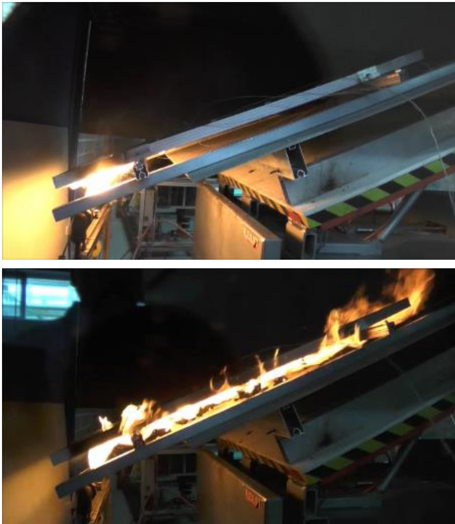
Abbildung 3: Brandversuch mit einer Brennerleistung von 25 kW (oben) und 150 kW (unten)
