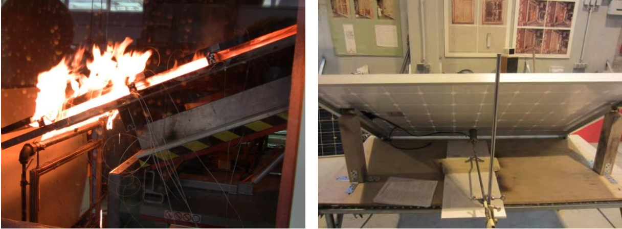
Bild 3-5: links: Versuchsaufbau TÜV/Currenta mit Flächenbrenner, Foto: TÜV Rheinland, Rechts: Versuchsaufbau BAM mit punktförmigem Gasbrenner in mittiger Positionierung, Foto BAM [12]
