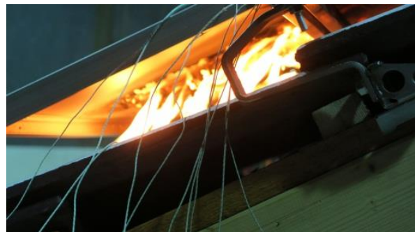
Bild 5-31: Links: Dachparalleler Aufbau mit Betondachsteinen und PV-Modul. Rechts: Zündinitial wurde zwischen Modul und Dachoberfläche platziert
