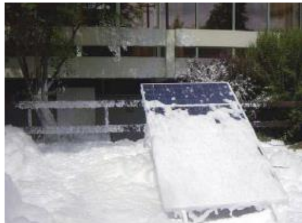
Bild 5-44: Versuche zur lichtdichten Abdeckung von PV-Modulen, Foto: http://pv-notaus.de/gefahren.html
