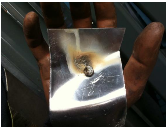
Bild 4-20: Einwirkung der Ströme auf die Kontaktflächen, Brandloch durch Stromeinwirkung
