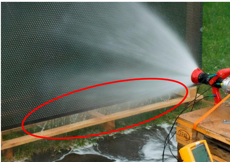
Bild 4-15: Ablaufendes Wasser bildet leitfähige Bahnen zum wasserbedeckten Boden – hier Sprühstrahl
