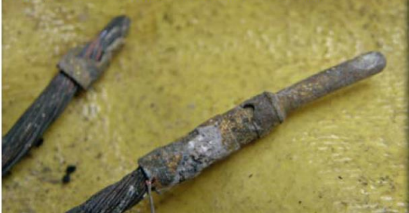
Bild 3-21: Reste zweier Steckverbinder aus dem Schutt eines Wohnhauses [9] (Foto: Institut für Schadenverhütung und Schadenforschung (IFS))
