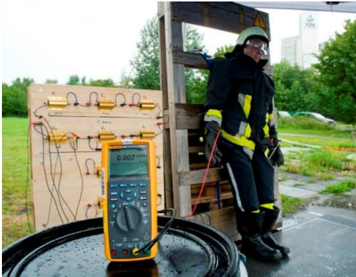
Bild 4-19: Versuchsaufbau mit Dummy und Schematisches Schaltbild
