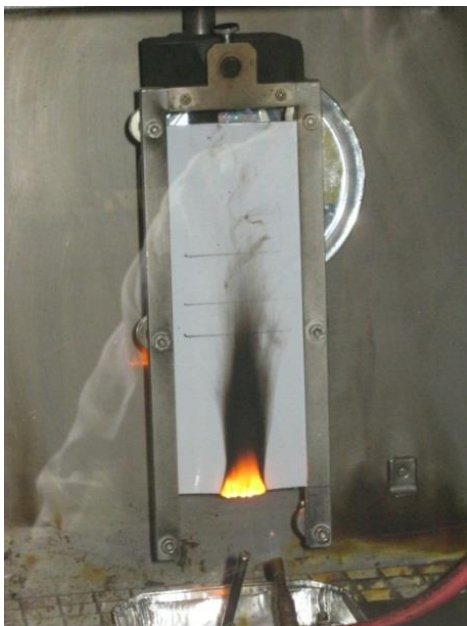
Bild 5-12: Prüfmethode zur Entflammbarkeit nach EN 13501-1
