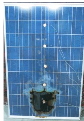
Bild 5-32: Ergebnis nach Prüfung. Modul wurde zerstört, kein Durchbrand in Dachoberfläche
