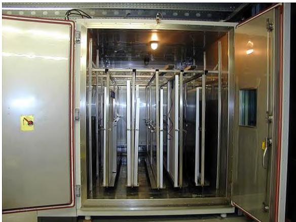
**Abbildung 76:** Klimakammer mit Modulen für thermomechanischen Stress
