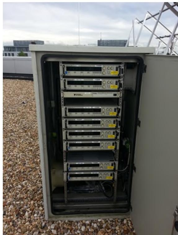
**Abbildung 57: Messdatenaufnahme / elektronische Lasten für Mpp-Tracking**
