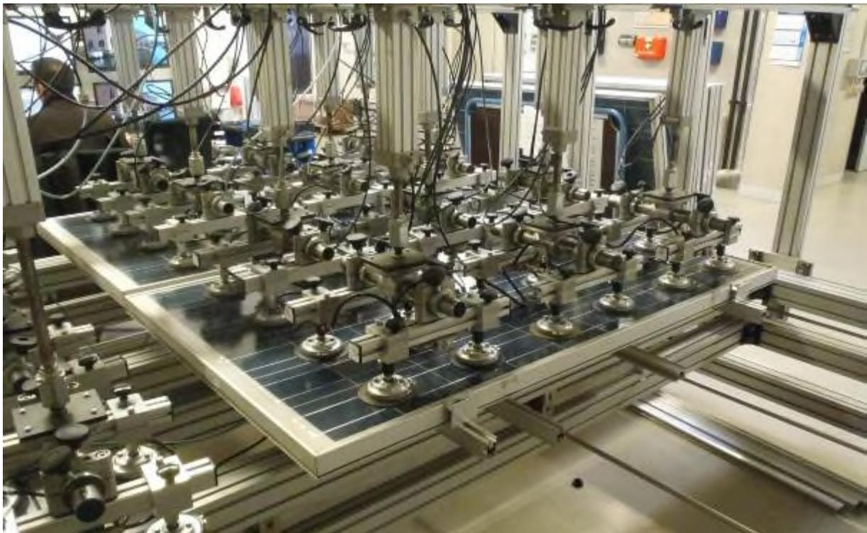
**Abbildung 82: Teststand zur dynamischen mechanischen Beanspruchung auf Druck und Zug**
