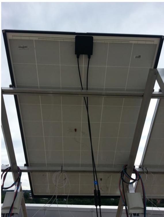
**Abbildung 56: Temperatursensoren auf der Modulrückseite**
