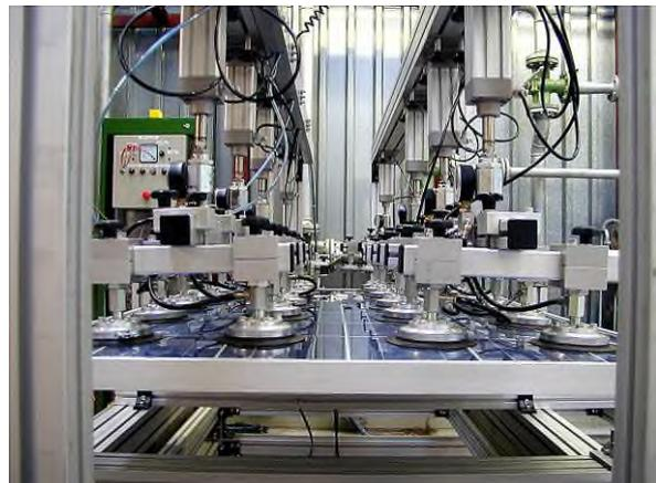
**Abbildung 77:** „Mechanical Load“- Tisch für dynamische Zug- und Druckbelastungen
