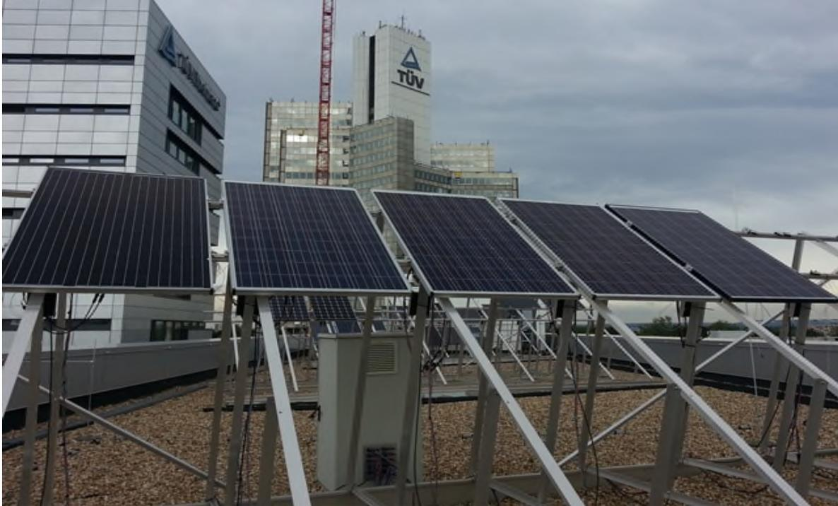
**Abbildung 55: Installation der 5 Testmuster zur Außenbelichtung mit Leistungsmonitoring**
